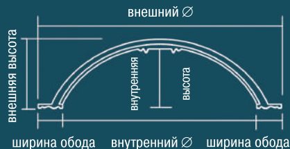
В2002 внутренний Ø 110,5 см внутренняя высота 17,0 см внешний Ø 129,5 см внешняя высота 19,0 см ширина обода 9,5 см
